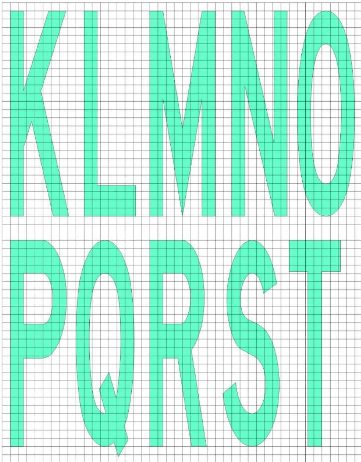
Rysunek L-10B. Kształt i proporcje liter i cyfr używanych do oznakowania poziomego nakazu
