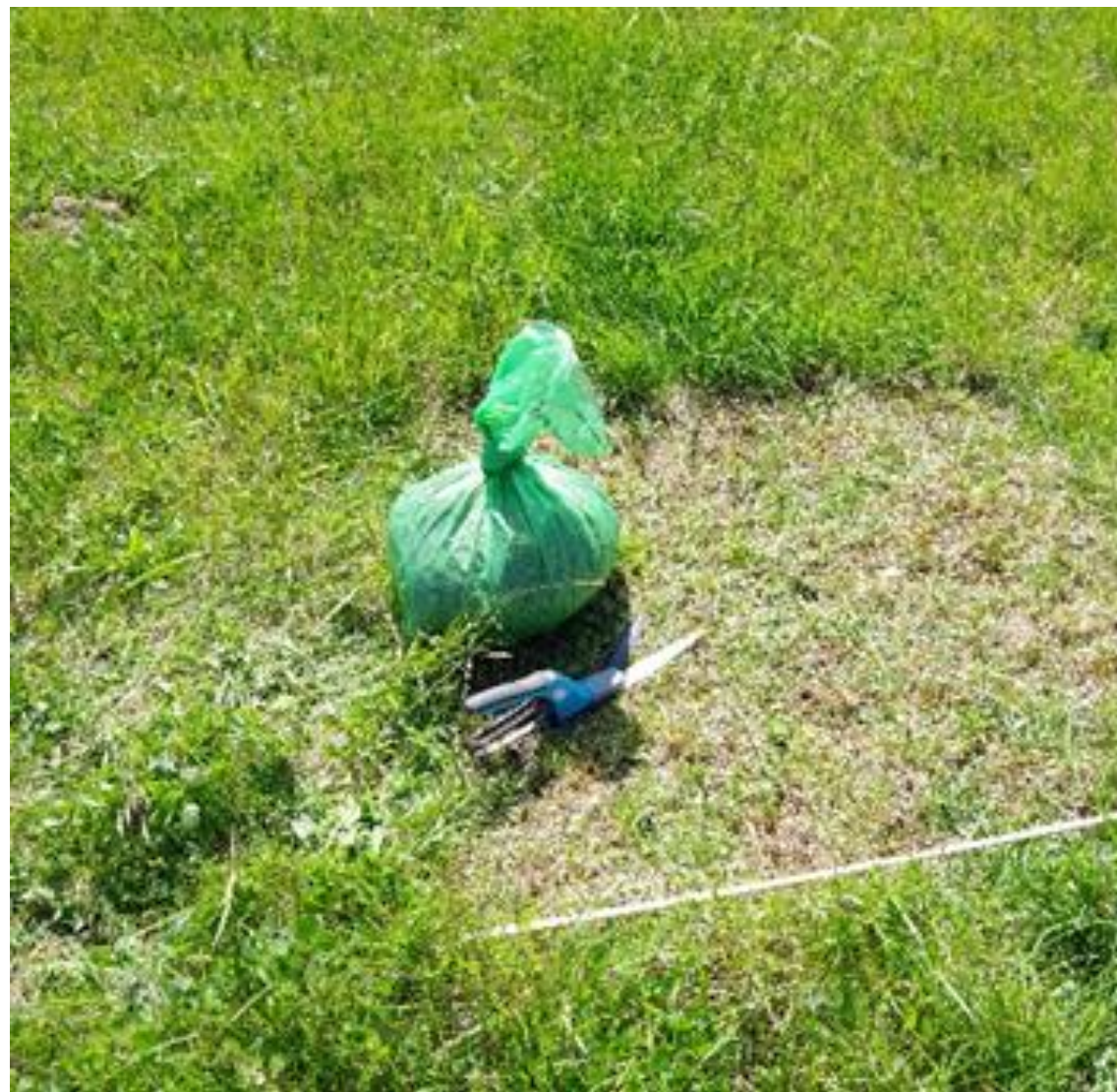
Rys.4. Sposób zbierania próbek trawy do badań- trawa wysoka
