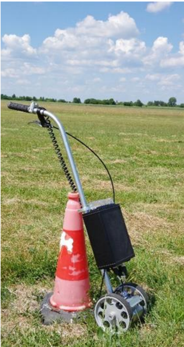
Rys.7. Przenośny tester powierzchni wykorzystany podczas badań
