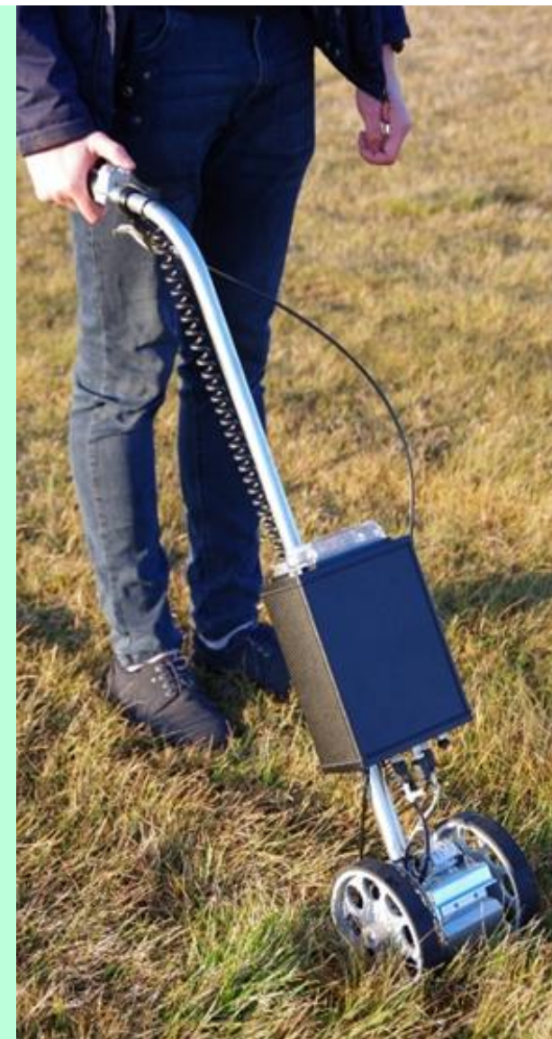
Rys.8. Sposób użycia przenośnego testera podczas badania nawierzchni trawiastego pasa startowego
