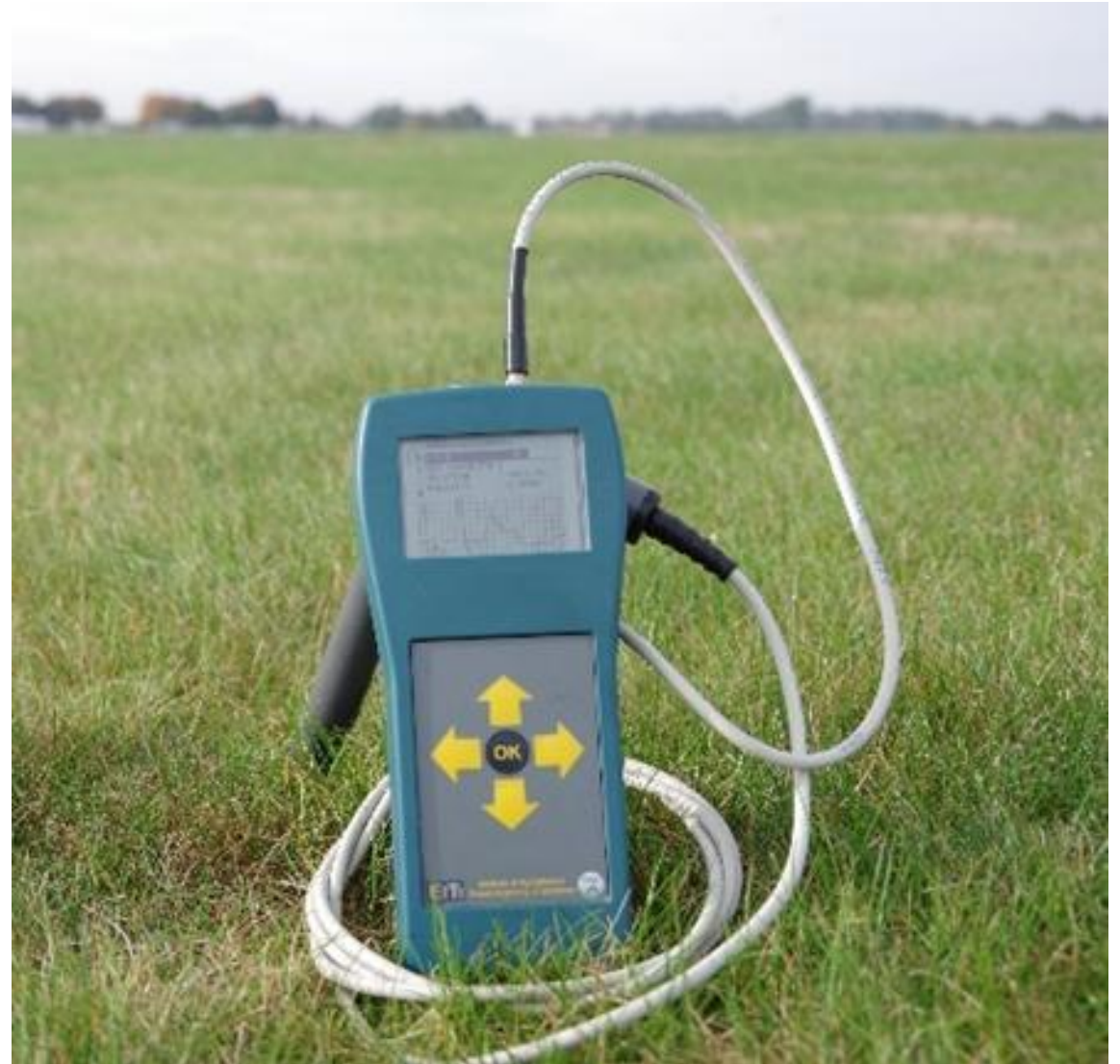
Rys.5. Miernik TDR wykorzystany do pobierania danych w trakcie prowadzonych badań
