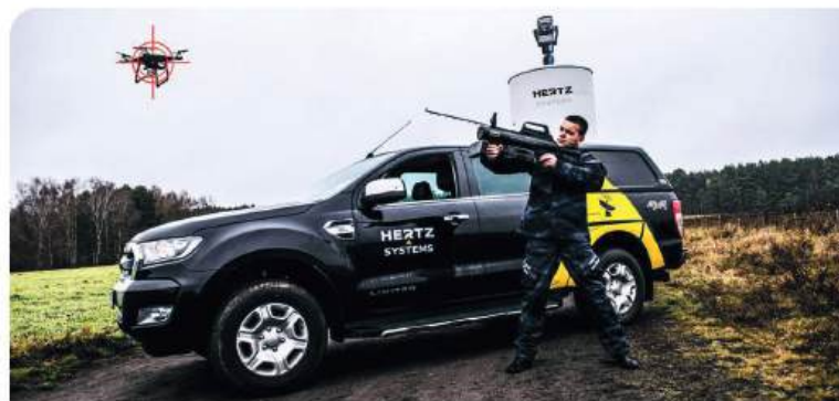
Rysunek 3. Mobilna wersja systemu „Jastrząb” z dookólnym radarem na platformie samochodowej i operatorem wyposażonym w elektromagnetyczny neutralizator Źródło: https://aviation24.pl/index.php/component/k2/item/2896-system-antydronowy-jastrzab-postrach-niepokornych-bezzałogowcow (14.05.2019 r.)
