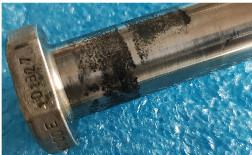
Rys. 1. Zdjęcie śruby z korozją.
