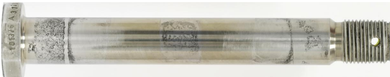
Rys. 1. Przykładowa postać korozji powierzchniowej i wżerowej.
