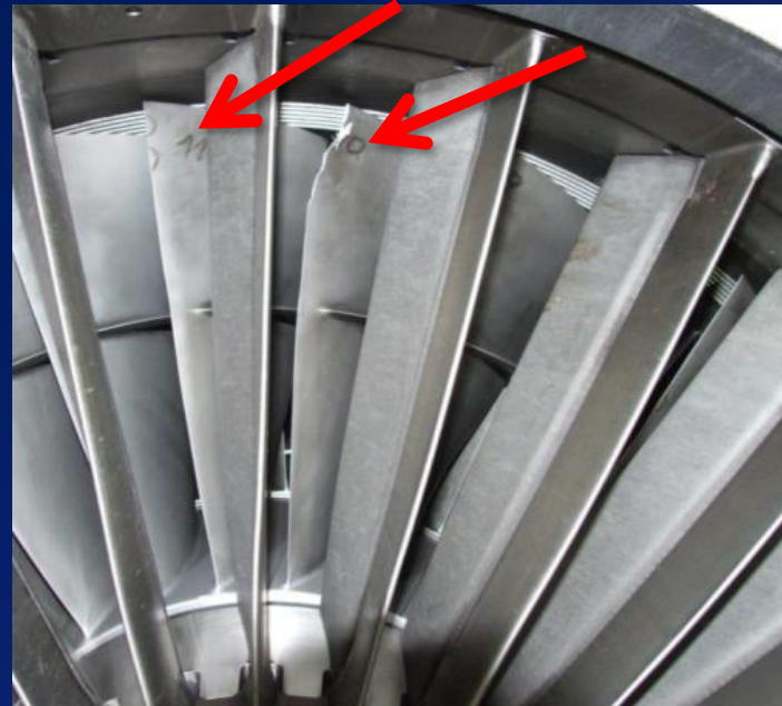
Uszkodzone łopatki silnika samolotu F-16
