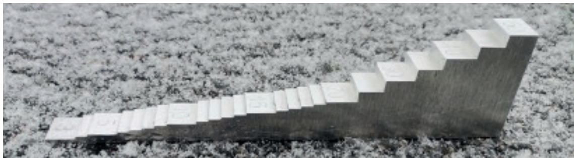
Rys. 4. Zdjęcie przyrządu do pomiaru grubości pokrycia.
