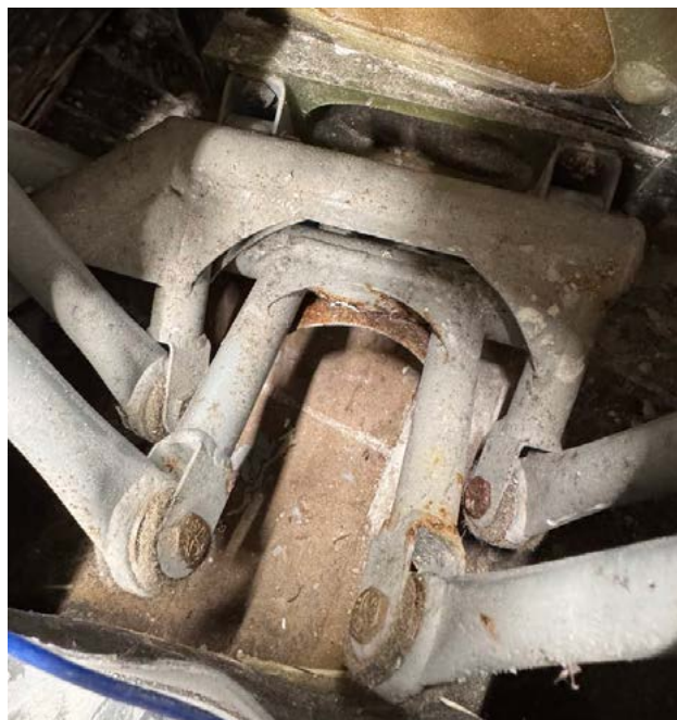
Fot. 6 Korozja nie do wykrycia bez demontażu głównego podzespołu - silnika
