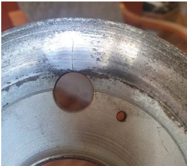
Fot. 5 Pęknięte, ale jeszcze działa
