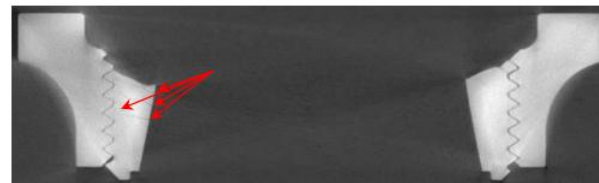
Rysunek 14. Przekroje elementu łopaty z widocznymi mikropęknięciami oznaczonymi czerwonymi strzałkami [Źródło: Politechnika Warszawska]
