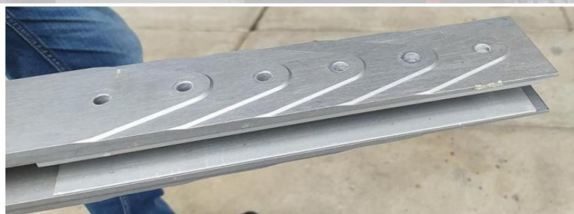
Rys. 28. Przykład łącznika łopatek wirnika wiatrakowca z zastosowaniem stopniowanego, kontrolowanego odsztywnienia łącznika poprzez zmianę jego grubości [źródło: PKBWL]
