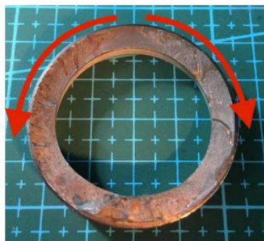
Rysunek 11. Kierunek propagacji pęknięcia [Źródło: Politechnika Warszawska]
