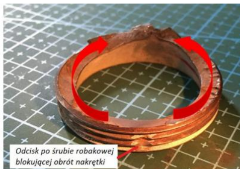
Rysunek 11. Kierunek propagacji pęknięcia [Źródło: Politechnika Warszawska]
