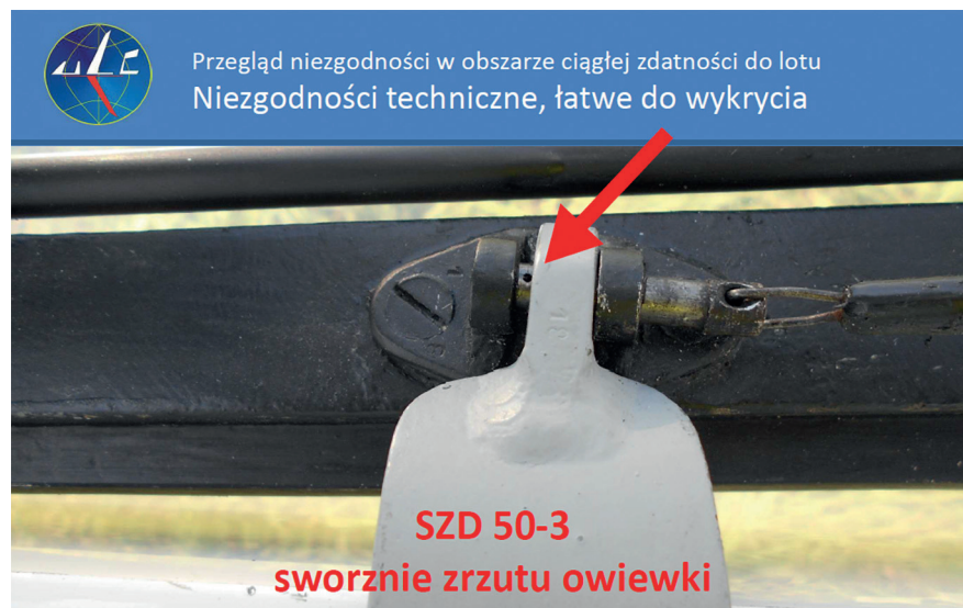
Fot. 4. Brak zabezpieczenia sworznia przed wysunięciem
