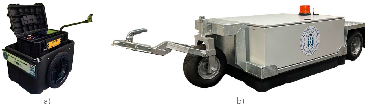
Rysunek 1 Platforma pomiarowa do badania jakości działania lamp AGL: Pierwszy prototyp (a), Drugi prototyp (b)
