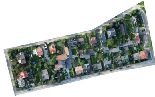
Rys. 4. Ortofotomozaika wygenerowana w programie Pix4D ze zdjęć uzyskanych podczas fotogrametrycznego lotu dronowego. Źródło: opracowanie własne.
