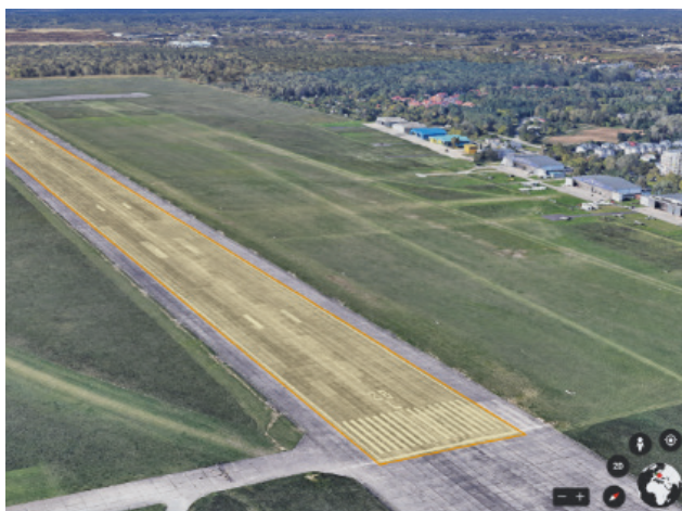
Rys. 1. Zrzut ekranu z etapu planowania lotu w programie Google Earth. Konturem pomarańczowym oznaczono przykładowy obszar do wykonania oblotu fotogrametrycznego. Źródło: opracowanie własne.
