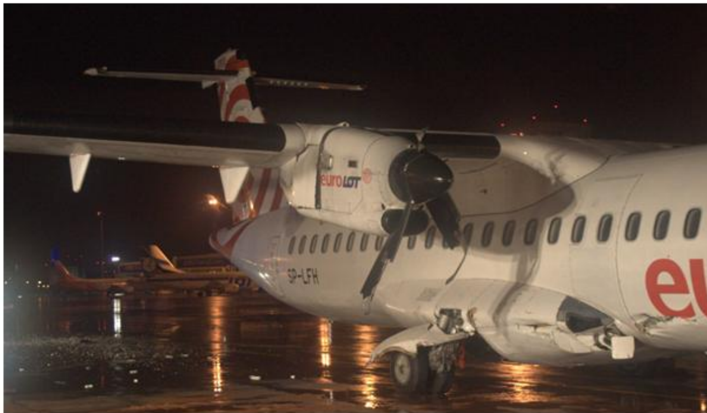
Zdjęcie 2 Uszkodzone śmigło, gondola podwozia oraz poszycie kadłuba. (zdjęcie LS Airport Service S.A.)
