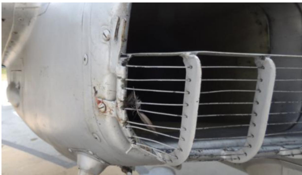
Zdjęcie 14. Autentyczne zdjęcie ze zderzenia statku powietrznego z ptakiem, niestety brak skali utrudnia określenie wielkości pióra. Uwaga: w tym przypadku o wielkości pióra można wnioskować na podstawie rozstawu drutów, jednak do prawidłowej oceny niezbędna jest wiedza z zakresu lotnictwa, której zwykle nie posiadają eksperci (np. ornitolodzy) dokonujący identyfikacji gatunku zwierzęcia. Zebranie piór zapewniłoby jednoznaczne oznaczenie gatunku przez eksperta ornitologa.
