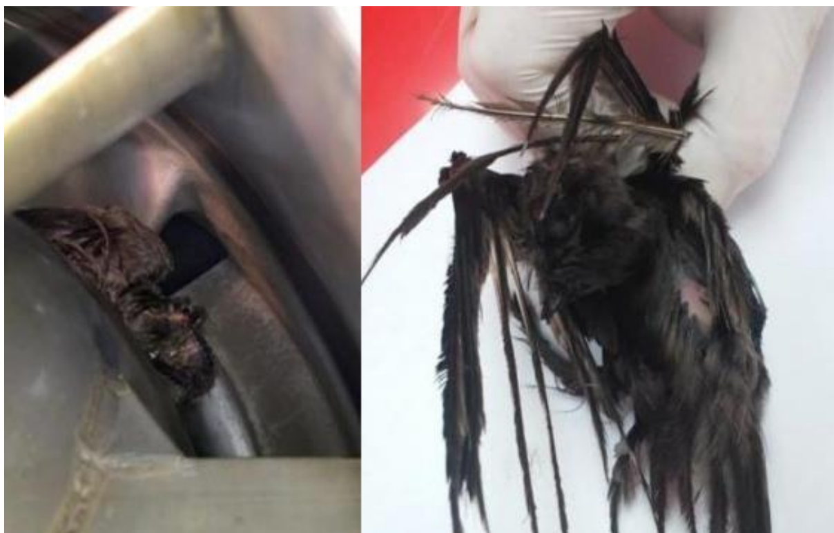
Zdjęcie 9. Autentyczne zdjęcia ze zderzenia z ptakiem, miejsce kolizji na statku powietrznym oraz zbliżenie szczątków. Widoczna część dłoni, ułatwiła weryfikację wielkości i identyfikację gatunku ptaka (jerzyk Apus apus ).
