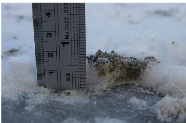
Wnikanie drobnego piasku i wody w zagęszczoną warstwę śniegu. Duże cząsteczki znajdują się na górze, podczas gdy drobniejszy piasek i woda przenikały w 10 mm warstwę śniegu.
