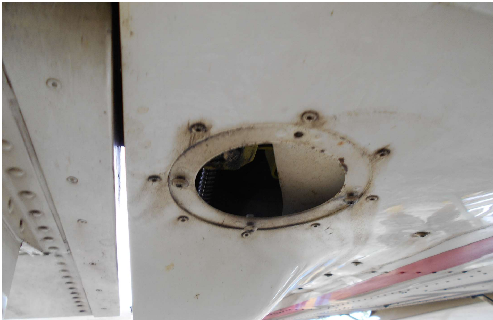
PAC 750 XL Brak pokrywy wziernika mechanizmu napędu klap.
