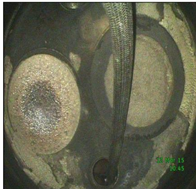
Widok głowicy cylindra nr 1 silnika IO – 240-B zabudowanego na samolocie DA20-C1 "Katana".
