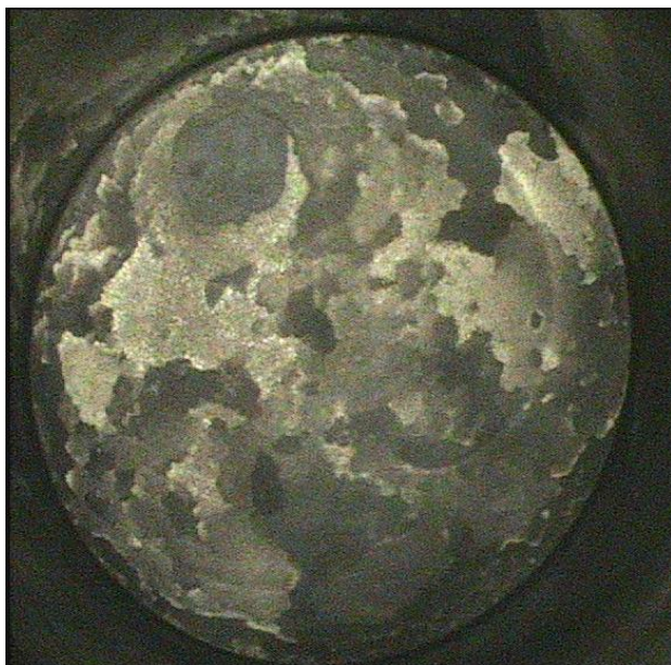
Widok tłoka cylindra nr 1 silnika IO-240-B zabudowanego na samolocie DA20-C1 "Katana".
