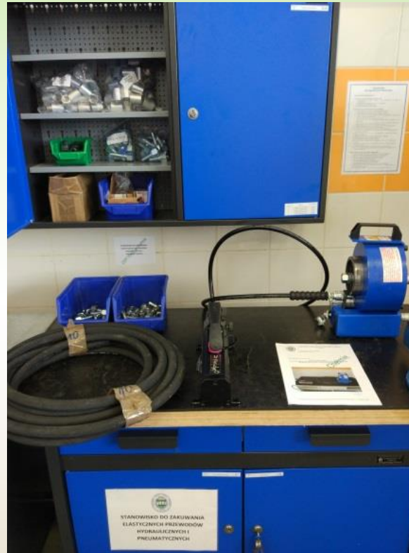
Stanowisko do zakuwania elastycznych przewodów hydraulicznych i pneumatycznych
