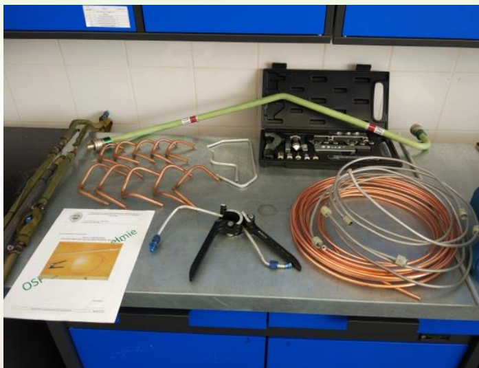
Stanowisko do gięcia metalowych przewodów hydraulicznych i pneumatycznych
