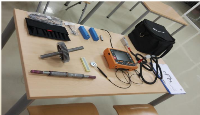
Stanowisko badań nieniszczących metodą prądów wirowych
