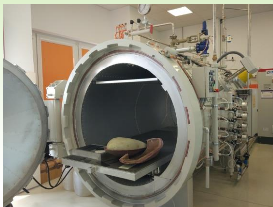
Stanowisko do wykonywania elementów kompozytowych metodą prepeg
