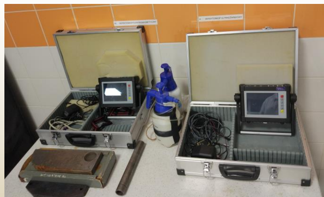
Stanowisko elektromagnetycznych badań nieniszczących
