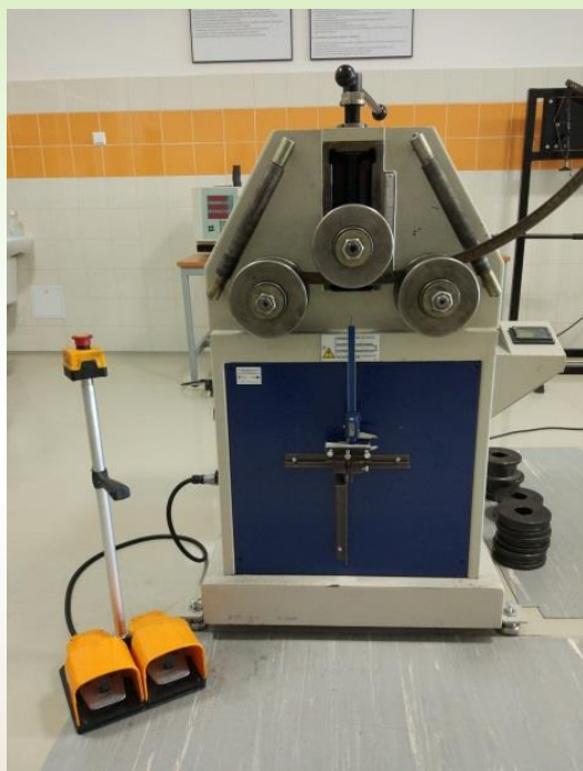
Stanowisko do gięcia metalowych przewodów hydraulicznych i pneumatycznych
