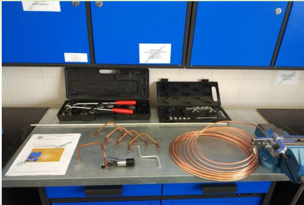
Stanowisko do kielichowania metalowych przewodów hydraulicznych i pneumatycznych
