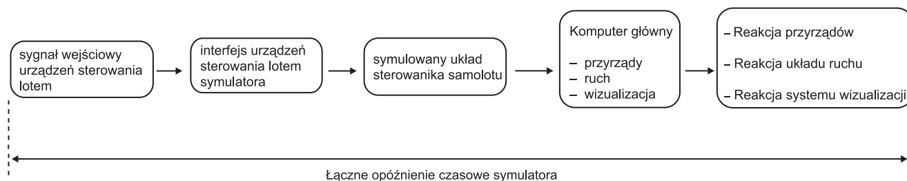
Rysunek 3. Opóźnienie czasowe dla symulacji statku powietrznego sterowanego komputerowo wykorzystującej emulację programową urządzeń statku powietrznego
