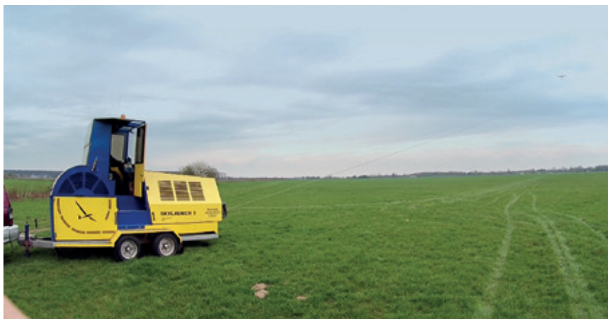
Typowa wyciągarka szybowcowa służąca do wynoszenia szybowców w powietrze.
